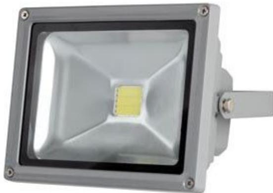
Faretto da esterno con lampada costituita da 1 LED bianco Epistar da 20 watt. Flusso luminoso: 1200 lumen, temperatura colore: 3000 K, angolo di emissione: 120°, grado di protezione IP65, alimentazione: 230 Vac. Completo di staffa di montaggio.
