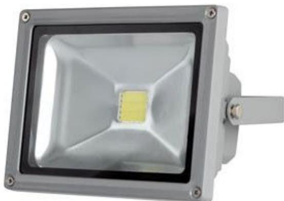
Faretto da esterno con lampada costituita da 1 LED bianco Epistar da 30 watt. Flusso luminoso: 1800 lumen, temperatura colore: 3000 K, angolo di emissione: 120°, grado di protezione IP65, alimentazione: 230 Vac. Completo di staffa di montaggio.
