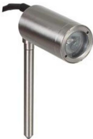
Faretto da giardino con LED da 1 watt, corpo in acciaio inox, diffusore in vetro e grado di protezione IP65. Indicato per l'illuminazione di piante, arbusti, ornamenti da giardino, vialetti, ecc. Alimentazione: 12 Vdc, flusso luminoso: 140 lm, temperatura colore: 6500 K, dimensioni: Ø 44 x 82 mm (250 mm incluso il picchetto), peso: 440 g.
