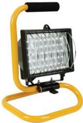
Faro alimentato a 230 Vac con lampada costituita da 45 LED bianchi. Flusso luminoso: 250 lumen, durata LED: 60.000 ore, classe di protezione IP44, dispone di vetro e griglia protettiva, manico con impugnatura morbida. Completo di accessori per il montaggio.
