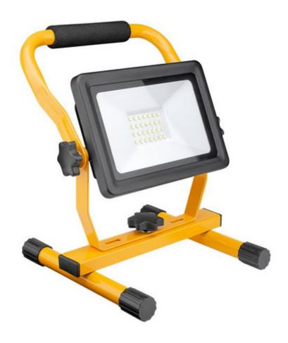
Faro da esterno (IP65) con lampada costituita da 28 LED a luce bianco freddo con una potenza totale di 30 watt. Realizzato in alluminio pressofuso con vetro temperato e supporto con impugnatura in spugna, dispone di testa orientabile, stabile supporto da pavimento, flusso luminoso: 2550 lumen, temperatura colore: 6500 K, angolo di emissione: 110°, grado di protezione IP65, alimentazione: 230 Vac. Ideale per illuminazione di grandi spazi, officine, garage, cantine, ecc.
