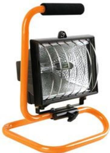
Faro alogeno alimentato a 230 Vac completo di lampada alogena classe C. Resistente alle intemperie (IP44), dispone di supporto, vetro con griglia protettiva e manico con impugnatura morbida. **N.B.** la lampada alogena in classe C fornisce una luce equivalente alle tradizionali lampadine a incandescenza, consumando circa il 20-25% in meno e durando il doppio.
