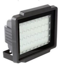
Faro alimentato a 230 Vac con lampada costituita da 45 LED bianchi. Flusso luminoso: 250 lumen, durata LED: 60.000 ore, classe di protezione IP44. Case plastico completo di accessori per il montaggio.
