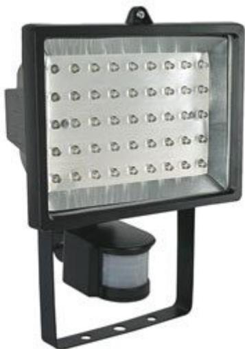
Faro alimentato a 230 Vac con lampada costituita da 45 LED bianchi e sensore PIR. Flusso luminoso: 250 lumen, durata LED: 60.000 ore, classe di protezione IP44. Completo di accessori per il montaggio.
