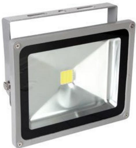
Faro da esterno con lampada costituita da 1 LED bianco Epistar da 10 watt. Flusso luminoso: 900-1000 lumen, temperatura colore: 6500K, angolo di emissione: 120°, grado di protezione IP65, alimentazione: 220 Vac. Completo di staffa di montaggio.
