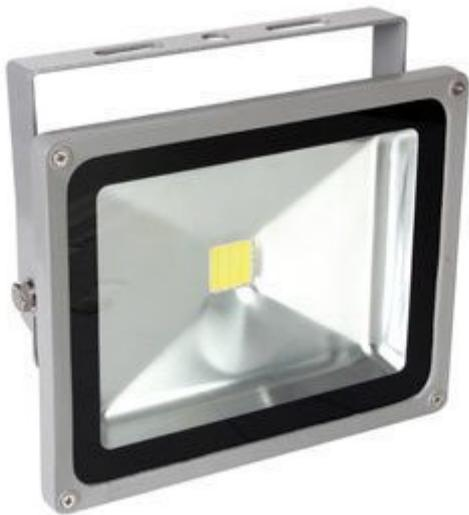
Faro da esterno con lampada costituita da 1 LED bianco Epistar da 30 watt. Flusso luminoso: 2700-3000 lumen, temperatura colore: 6500K, angolo di emissione: 120°, grado di protezione IP65, alimentazione: 220 Vac. Completo di staffa di montaggio.
