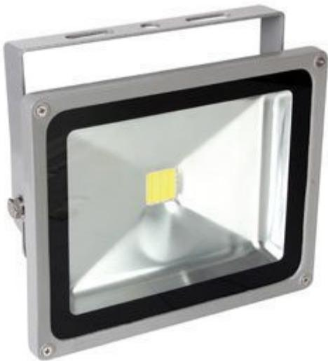
Faro da esterno con lampada costituita da 1 LED bianco Epistar da 50 watt. Flusso luminoso: 4500 - 5000 lumen, temperatura colore: 6500K, angolo di emissione: 120°, grado di protezione IP65, alimentazione: 220 Vac. Completo di staffa di montaggio.
