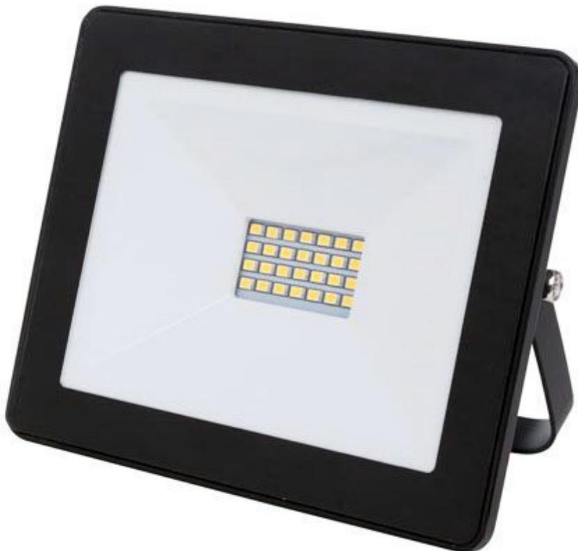
Faretto da esterno ultrasottile (3,2 cm di spessore), con lampada costituita da 28 LED in SMD tipo 2835 a luce bianca neutra con una potenza totale di 20 watt. Dispone di corpo in alluminio pressofuso con vetro temperato, e costine per la massima dissipazione del calore. Flusso luminoso: 1600 lumen, temperatura colore: 4000 K, angolo di emissione: 120°, grado di protezione IP65, alimentazione: 230 Vac. Completo di staffa di montaggio regolabile.
