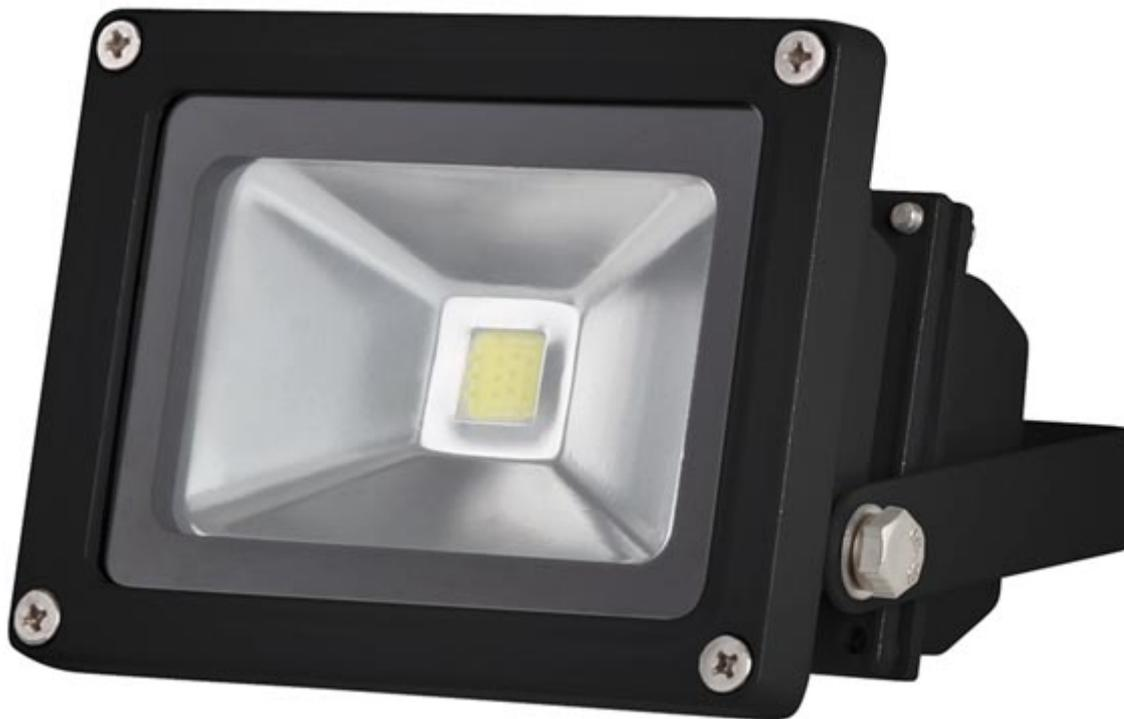
Faretto da esterno con lampada costituita da 1 LED bianco Epistar a luce calda da 10 watt. Dispone di corpo in alluminio pressofuso con vetro temperato, e costine per la massima dissipazione del calore. Flusso luminoso: 600 lumen, temperatura colore: 3000 K, angolo di emissione: 120°, grado di protezione IP65, alimentazione: 230 Vac. Completo di staffa di montaggio regolabile.
