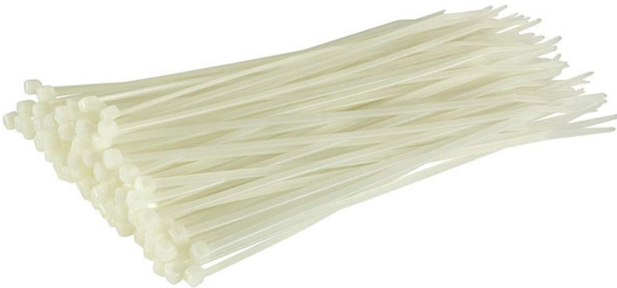
Confezione contenente 100 fascette serracavo in nylon, resistenti ai raggi UV, colore bianco trasparente, lunghezza 200 mm, larghezza 2,5 mm, resistente alla rottura: 8,1 kg, temperatura operativa: da -35°C a +85°C. Fornisce una presa sicura per lavori di bricolage e gestione dei cavi.
