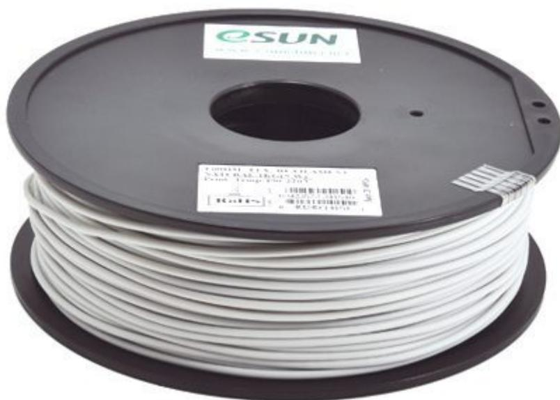
Filamento flessibile neutro con diametro da 1,75 mm specifico per stampanti 3D dotate di estrusore in grado di raggiungere temperature elevate (almeno 260°C). È un genere di materiale morbido, con elevata flessibilità e resistenza meccanica, resistenza all'usura e all'invecchiamento, a prova di freddo e anti UV (resistenza all'ingiallimento, in grado di sopportare l'esposizione al sole).
