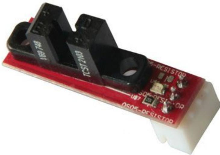
Costituita da un interruttore ottico a forcella e un LED, questa piccola scheda è particolarmente indicata per essere utilizzata come finecorsa ottico per stampanti 3D o CNC. Dimensioni (mm): 33x14x10,5. Completa di cavetto lungo 48 cm.
