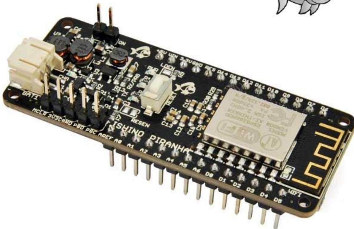
Piranha è una board con le stesse dimensioni dell'Arduino MKR1000. Basata sul microcontrollore PIC32MX470F512, dispone di 512 kB di ROM, 128 kB di RAM, un clock a 120 MHz, interfaccia USB nativa (sia Device che Host), RTC integrato, supporto per schede di memoria microSD, modulo WiFi, alimentazione a batteria (plug e/o via connettore USB, da 3 volt circa fino a 20 volt), ricarica automatica di una batteria LiPo (se presente l'alimentazione esterna).
