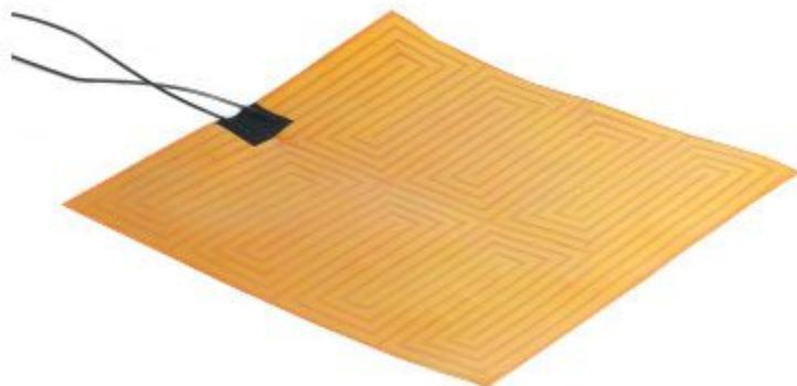
Realizzato in Kapton e dotato di una serpentina elettrica che si alimenta a 12 Vdc, questo foglio adesivo permette di ottenere una superficie riscaldata da utilizzare con la vostra stampante 3D. Dimensioni (cm): 23x23, massima potenza a 12 Vdc: 120 watt, corrente massima: 10 A, temperatura massima a 12 Vdc: 90°C, lunghezza dei fili di alimentazione: 60 cm.
