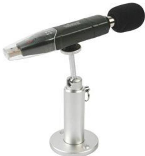
Fonometro digitale con Data Logger in grado di memorizzare fino a 129.920 dati. È in grado di misurare intensità sonore comprese tra 30 e 130dB. Dispone di microfono a condensatore, intervallo di campionamento 1s-24h, curve di pesatura A e C, gamma di frequenza da 31,5Hz a 8kHz, interfaccia USB per trasferimento dati. Autonomia circa 200 ore, dimensioni 130x30x25 mm. Software di calibrazione e batteria, inclusi.
