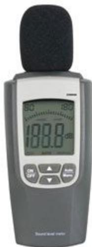
Fonometro con risoluzione di 0,1 dB ed indicazione digitale della misura. È in grado di rilevare intensità sonore comprese tra 30 e 120 dB. Dispone delle seguenti funzioni: cambio portata manuale/automatico, indicazione OVER e UNDER (indica UNDER quando l'intervallo selezionato è troppo alto, indica OVER quando l'intervallo selezionato è troppo basso), spegnimento automatico e indicatore di batteria scarica.
