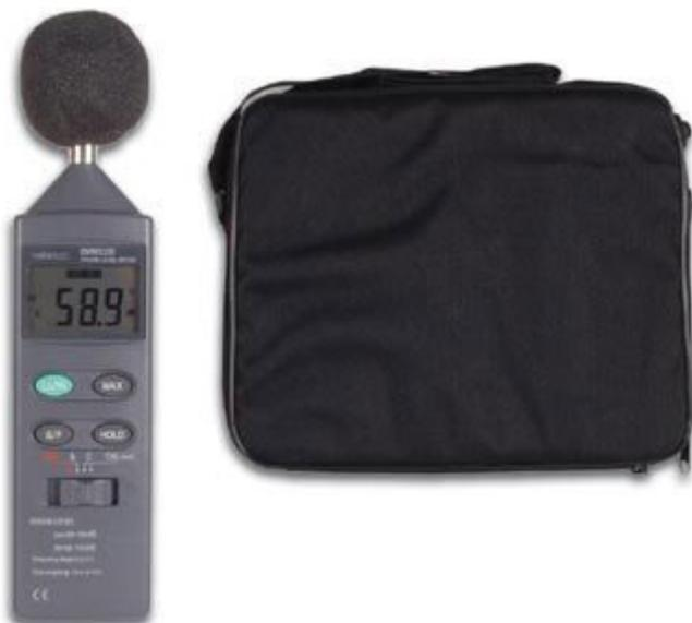
Strumento professionale con risoluzione di 0,1 dB ed indicazione digitale della misura. E' in grado di rilevare intensità sonore comprese tra 35 e 130 dB in due scale. Completo di custodia e batteria di alimentazione.
