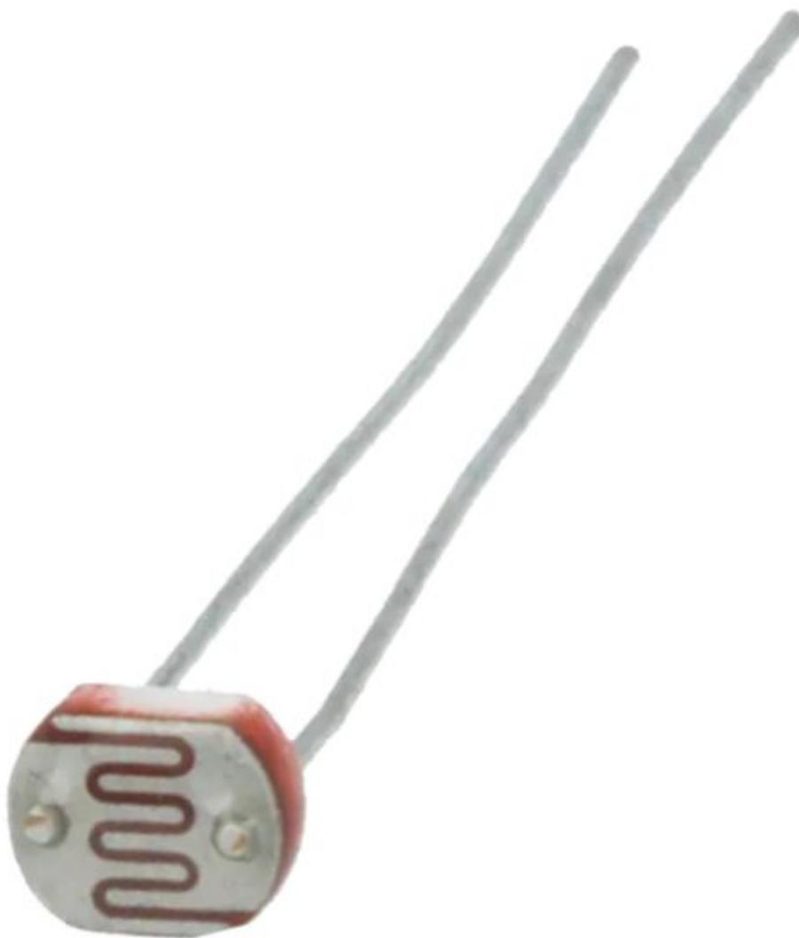
Fotoresistenza LDR 2-20K. Specifiche: fotoresistenza (min - max): 2-20 kohm, resistenza in assenza di luce (dopo 10 sec.): > 2 Mohm, gamma a 10-100 Lux: 0.7, potenza max dissipata: 100mW, tensione massima applicabile: 150Vdc, risposta spettrale di picco: 540nm, tempo di risposta in salita: 20ms, tempo di risposta in caduta: 30ms, temperatura di lavoro: -30
