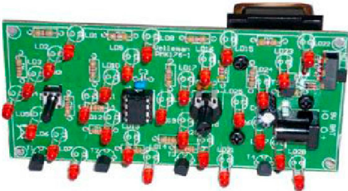
Dispone di 28 LED da 3mm ad elevata intensità luminosa ed è caratterizzata da 10 differenti tipi di animazione (scorrimento, scorrimento inverso, lampeggio, lampeggio parziale ecc...). Velocità d'esecuzione dell'animazione regolabile. Ideale per segnalazioni o per attirare l'attenzione.
