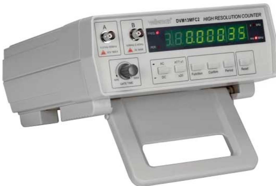
Frequenzimetro a due canali con display digitale con LED verdi a 8 digit in grado di lavorare con frequenze comprese tra 0,01 Hz e 2,4 GHz.
