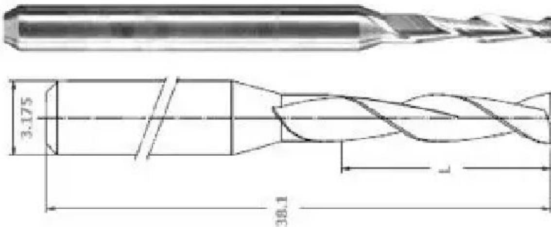
Fresa 2 taglienti 2 mm specifica per alluminio, rame, ottone e materiali teneri quali PE, PTFE, PMMA, Poliammide ecc. Punta piatta. Lunghezza fresa: 38,1 mm, lunghezza tagliente: 11,5 mm, diametro gambo: 3,175 mm.
