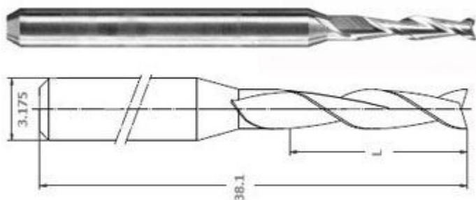
Fresa 2 taglienti 3 mm specifica per alluminio, rame, ottone e materiali teneri quali PE, PTFE, PMMA, Poliammide ecc. Punta a lisca di pesce. Lunghezza fresa: 38,1 mm, lunghezza tagliente: 14,5 mm, diametro gambo: 3,175 mm.
