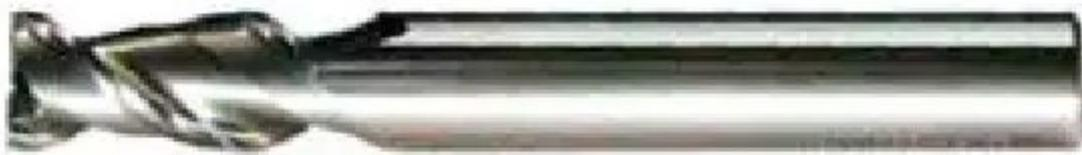
Fresa 2 taglienti specifica per alluminio e materiali plastici. Lunghezza fresa: 75 mm, lunghezza tagliente: 11 mm, diametro gambo: 4 mm.
