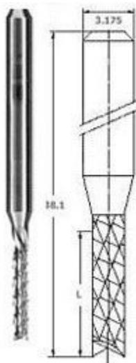
Fresa ad alta velocità in metallo duro adatta per lavorazioni di materiali a base di fibra di vetro, compensati o per la lavorazione dei circuiti stampati. Ottima nelle lavorazioni interne e esterne. Lunghezza fresa: 38,1 mm, lunghezza tagliente: 14 mm, diametro gambo: 3,175 mm.
