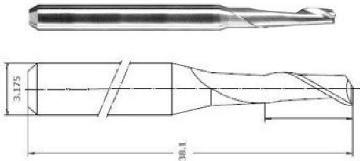
Fresa mono tagliante 1 mm specifica per alluminio, rame, ottone e materiali teneri quali PE, PTFE, PMMA, Poliammide ecc. Lunghezza fresa: 38,1 mm, lunghezza tagliente: 6 mm, diametro gambo: 3,175 mm.
