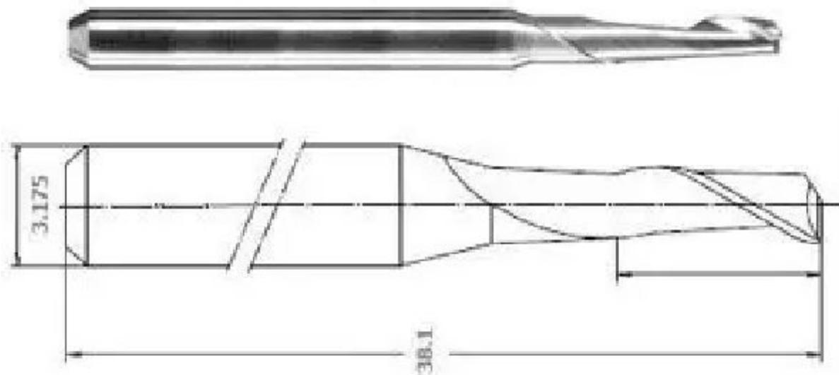
Fresa mono tagliante 2 mm specifica per alluminio, rame, ottone e materiali teneri quali PE, PTFE, PMMA, Poliammide ecc. Lunghezza fresa: 38,1 mm, lunghezza tagliente: 12,5 mm, diametro gambo: 3,175 mm.
