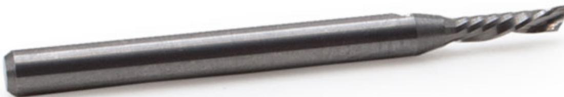
Questa fresa con un tagliente da 2 mm offre una superficie di taglio liscia e garantisce un'efficace eliminazione dei trucioli. Realizzata in acciaio al tungsteno, questa fresa è ideale per una vasta gamma di materiali, tra cui acrilico, PVC, MDF, plastica, legno, nylon e resina. La sua buona durezza e il tagliente estremamente affilato la rendono una scelta affidabile e durevole per lavori di fresatura.
