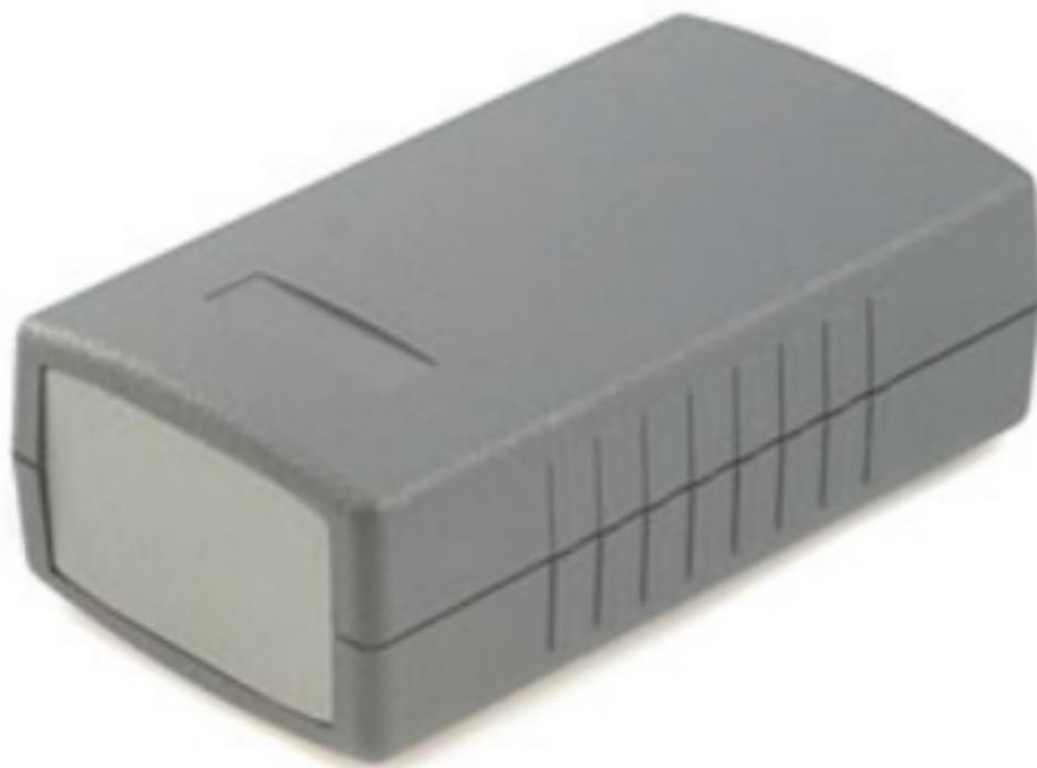
Ideale per strumentazione ed apparecchiature per telecomunicazioni, sia per dispositivi portatili che da laboratorio. Realizzato in ABS antiurto autoestinguente, risponde alle normative UL94-V0. Il contenitore, di classe IP54 per quanto la protezione all'acqua e alla polvere, dispone di una chiusura a guscio con due pannelli plastici alle estremità. Le scanalature e le sporgenze interne consentono di alloggiare circuiti stampati sia in posizione verticale che orizzontale.
