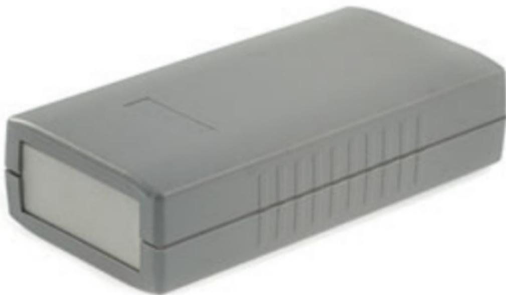
Ideale per strumentazione ed apparecchiature per telecomunicazioni, sia per dispositivi portatili che da laboratorio. Realizzato in ABS antiurto autoestinguente, risponde alle normative UL94-V0. Il contenitore, di classe IP54 per quanto la protezione all'acqua e alla polvere, dispone di una chiusura a guscio con due pannelli plastici alle estremità. Le scanalature e le sporgenze interne consentono di alloggiare circuiti stampati sia in posizione verticale che orizzontale.
