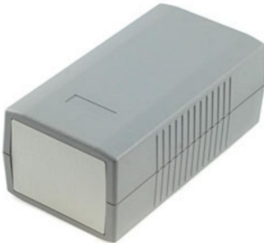
Ideale per strumentazione ed apparecchiature per telecomunicazioni, sia per dispositivi portatili che da laboratorio. Realizzato in ABS antiurto autoestinguente, risponde alle normative UL94-V0. Il contenitore, di classe IP54 per quanto la protezione all'acqua e alla polvere, dispone di una chiusura a guscio con due pannelli plastici alle estremità. Le scanalature e le sporgenze interne consentono di alloggiare circuiti stampati sia in posizione verticale che orizzontale.
