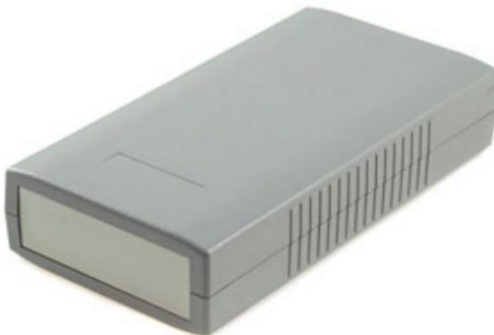
Ideale per strumentazione ed apparecchiature per telecomunicazioni, sia per dispositivi portatili che da laboratorio. Realizzato in ABS antiurto autoestinguente, risponde alle normative UL94-V0. Il contenitore, di classe IP54 per quanto la protezione all'acqua e alla polvere, dispone di una chiusura a guscio con due pannelli plastici alle estremità. Le scanalature e le sporgenze interne consentono di alloggiare circuiti stampati sia in posizione verticale che orizzontale.
