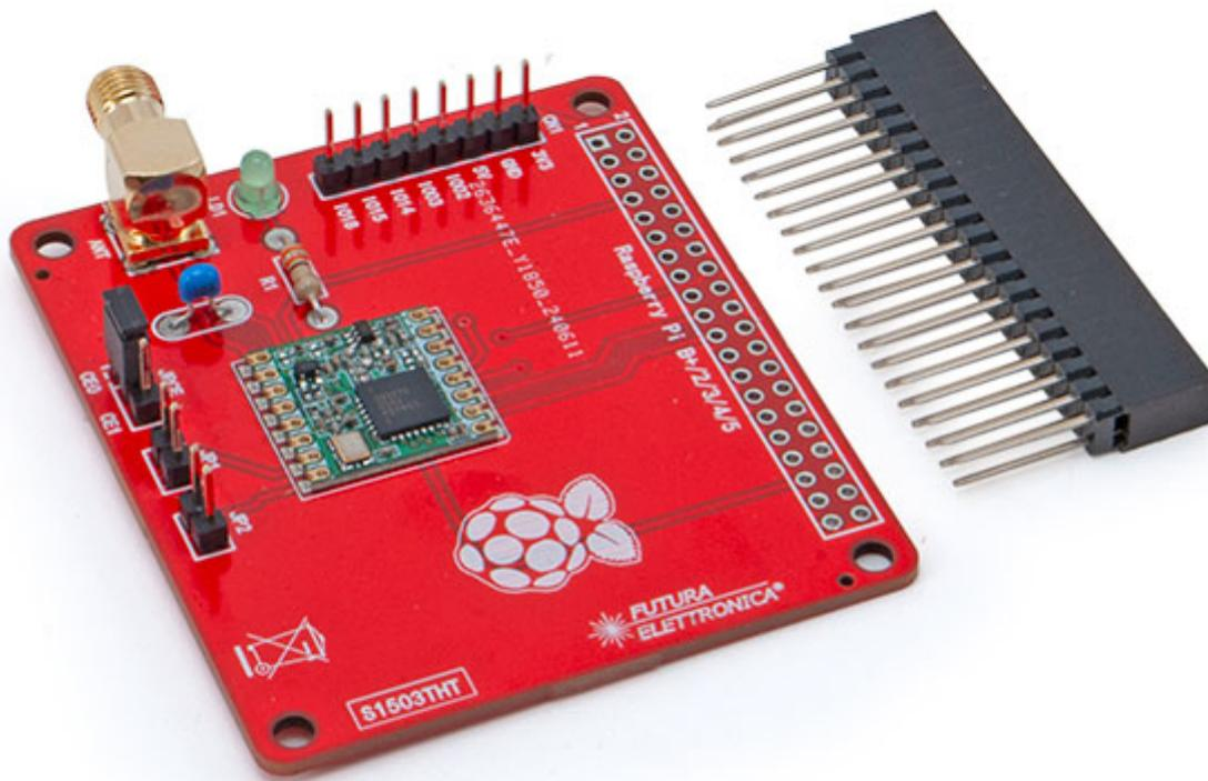
Board LoRa 868MHz a singolo canale per Raspberry Pi, basata sul potente modulo RTX Long Range (RFM95-868). Progettata per offrire una comunicazione a lungo raggio, questa scheda dispone di un LED di segnalazione, jumper di configurazione e un connettore SMA per l'antenna (non inclusa, disponibile nei prodotti correlati). Ideale per progetti IoT, la board può comunicare con decine o addirittura centinaia di dispositivi finali in modalità punto-punto.
