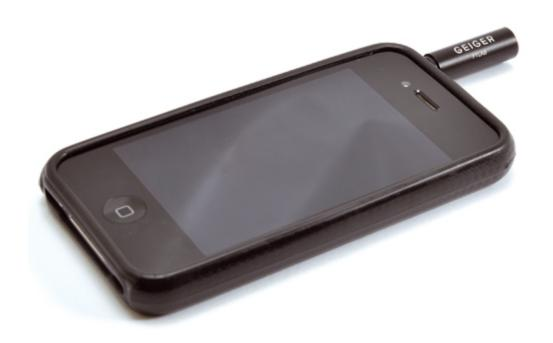
Contatore Geiger ultra compatto per smartphone, basato su un piccolo sensore a semiconduttore. Si inserisce direttamente nella presa cuffie di uno smartphone, sul quale deve essere installata l'apposita App gratuita (disponibile per Android e iOS), ed è in grado di rilevare le radiazioni Gamma e i raggi X presenti nell'ambiente. Non necessita di alcuna sorgente di alimentazione, si alimenta direttamente dalla presa cuffie dello smartphone.
