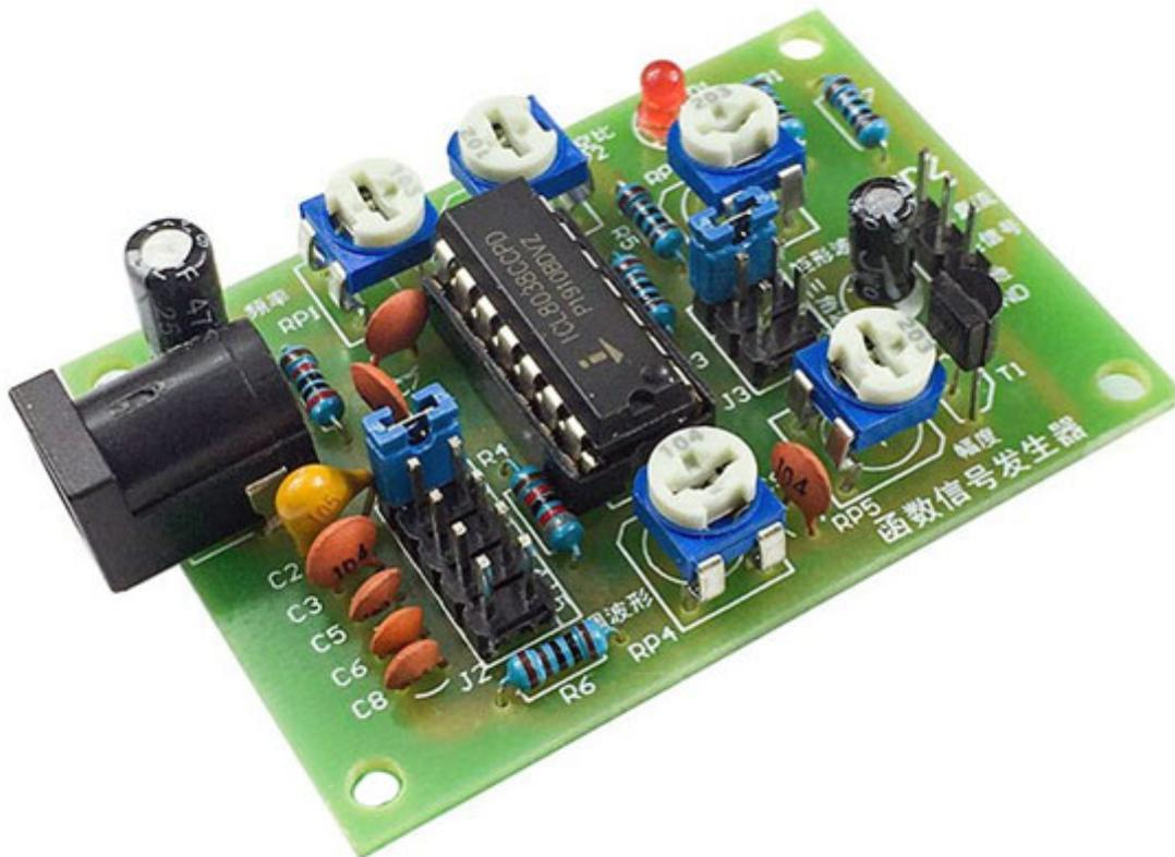
Generatore di forme d'onda in kit basato sul chip ICL8038. È in grado di generare segnali di uscita a onda sinusoidale, triangolare e quadra. Dispone di 5 differenti range di frequenza (da 10 Hz a 450 Hz, da 90 Hz a 1,5 kHz, da 940 Hz a 15 kHz, da 5 kHz a 120 kHz, da 20 kHz a 450 kHz) selezionabili tramite jumper, LED di stato per l'alimentazione, 5 trimmer di regolazione (frequenza, duty cycle, onda quadra, onda sinusoidale, ampiezza di uscita). Alimentazione: da 12 e 24 VDC.
