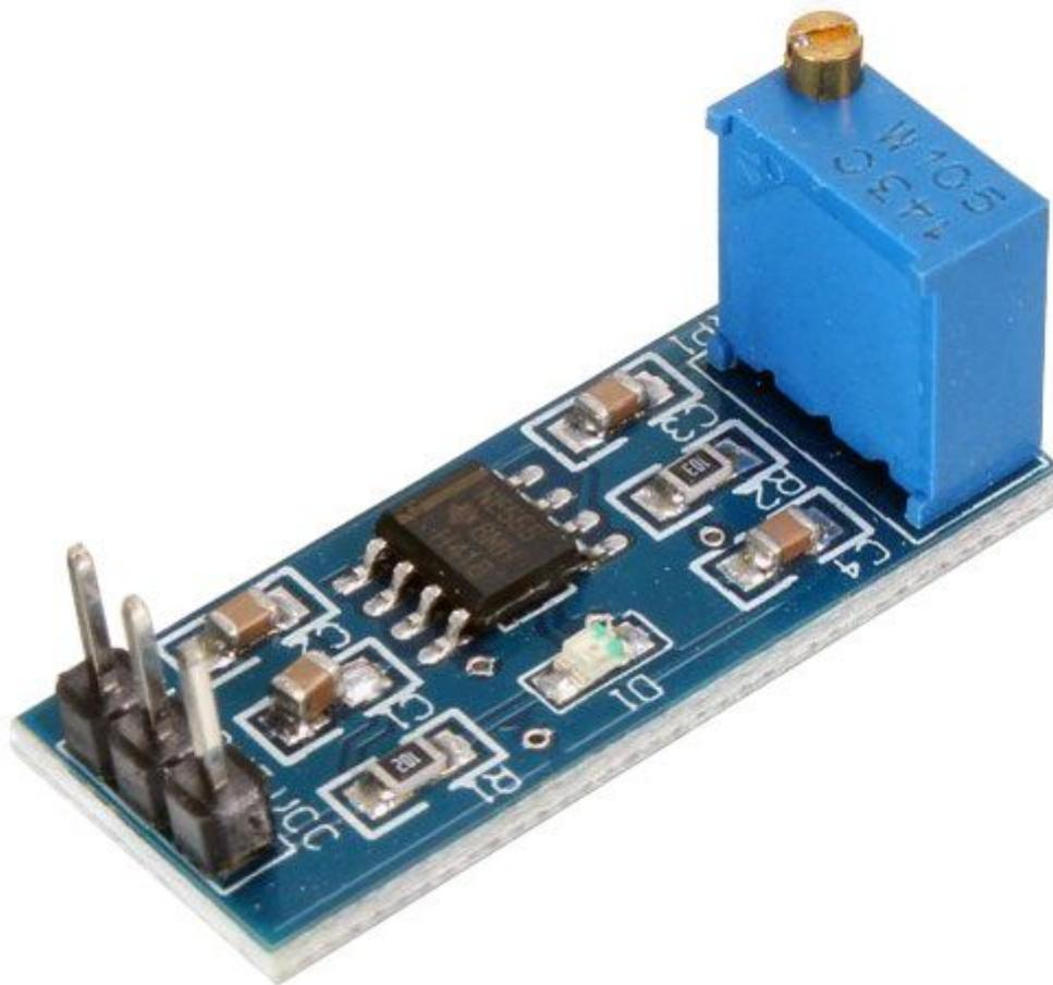
Basato sull'integrato 555 (versione SMD), questo piccolo modulo permette di generare un segnale ad onda quadra da 3,7 Hz a 1,3 kHz, regolabile tramite l'apposito trimmer multigiri. Sul modulo è presente anche un LED di stato per l'alimentazione. Alimentazione: da 5 a 12 VDC, dimensioni (mm): 29x12x12.
