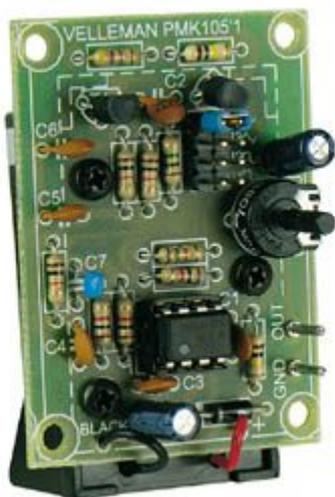
Segnali di uscita: onda sinusoidale, triangolare, quadrata e integratore (selezionabile tramite ponticello). Frequenza del segnale: circa 1 kHz (fissa). Ampiezza del segnale: regolabile da 0 a 100 mV rms per mezzo del potenziometro LEVEL.
