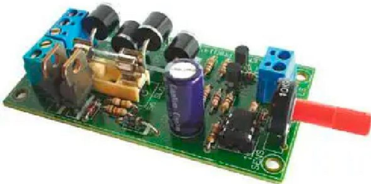
Circuito sicuro poiché gestito in bassa tensione. Consente di fare lampeggiare un lampada al ritmo della musica. Utilizzabile anche per lampade alogene. Da collegare in parallelo all'altoparlante da cui proviene l'audio: questo ingresso è optoisolato. Sensibilità regolabile. Può essere utilizzato in automobile se la lampada è isolata dal telaio.
