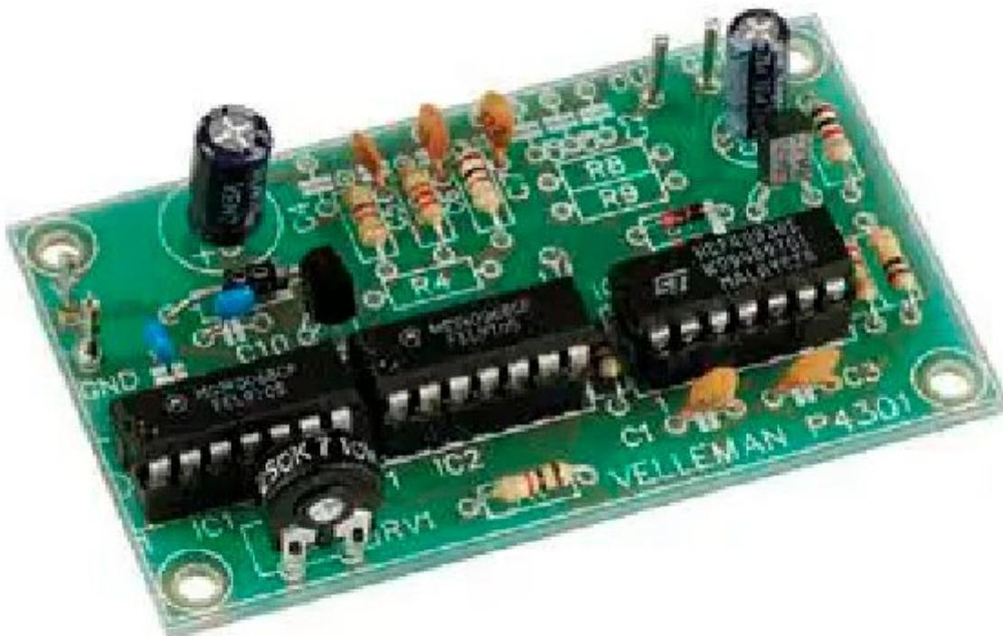
Per analizzare le caratteristiche acustiche di un locale (solitamente un salotto), è indispensabile utilizzare, insieme ad un analizzatore di spettro, un buon generatore di rumore rosa. E' necessario, inoltre, un microfono con caratteristiche di frequenza il più possibile lineari (da 20 Hz a 20 kHz). Se avete a disposizione un equalizzatore, allora la risposta potrà non solo essere analizzata, ma anche corretta. Facilmente modificabile per produrre "rumore bianco".
