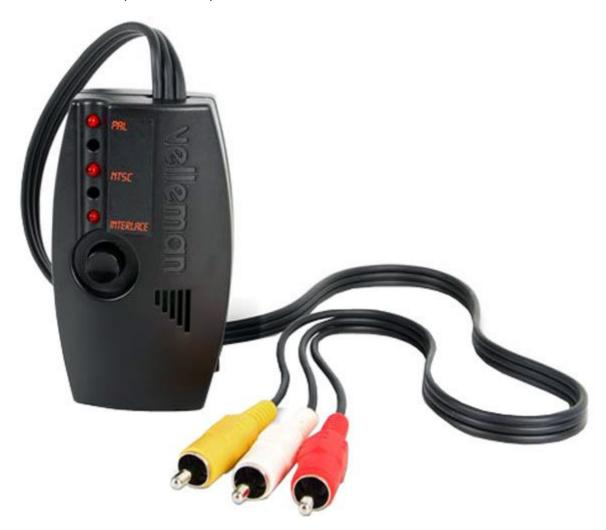
Generatore video pattern tascabile gestito da microcontrollore. Produce fino a 12 differenti pattern video o sarà possibile analizzare la qualità dell'immagine di TV o monitor. L'uscita del segnale video può essere s
