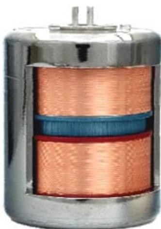
Trasduttore elettromeccanico, conosciuto come "Geofono", trasforma il movimento del suolo (o onde sismiche) in un segnale elettrico che può essere facilmente letto da un microcontrollore. Progettato per offrire le massime prestazioni, questo geofono verticale a bassa distorsione, dispone di una frequenza naturale di 10 Hz, una sensibilità di 28,8 V/m/s, una distorsione tipica dello 0,03% e una larghezza di banda da 10 Hz a 240 kHz.
