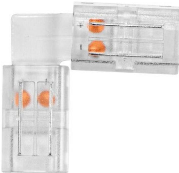
Giunto a "L" per strip a LED con larghezza 10 mm, senza rivestimento in silicone o con rivestimento in silicone da un solo lato. Numero contatti: 2, max. tensione contatti: 36 VDC, corrente: max. 5 A, resistenza al calore fino a 105°C.
