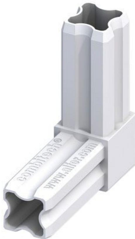
Giunto plastico ad angolo 90° con 2 perni. Realizzato appositamente per essere utilizzato con il tubo in alluminio quadro 23,5x23,5 (vedere prodotti correlati). I perni si inseriscono all'interno del tubo.
