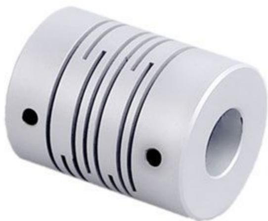
Giunto flessibile in alluminio per barra filettata asse Z stampante 3DRAG. Diametro esterno: 16 mm, lunghezza: 23 mm, diametro interno: 5 mm / 8 mm. Massima forza di torsione: 1 Nm, flessione assiale: +/- 0,4 mm, flessione laterale: 0,1 mm, peso: 8,1 grammi.
