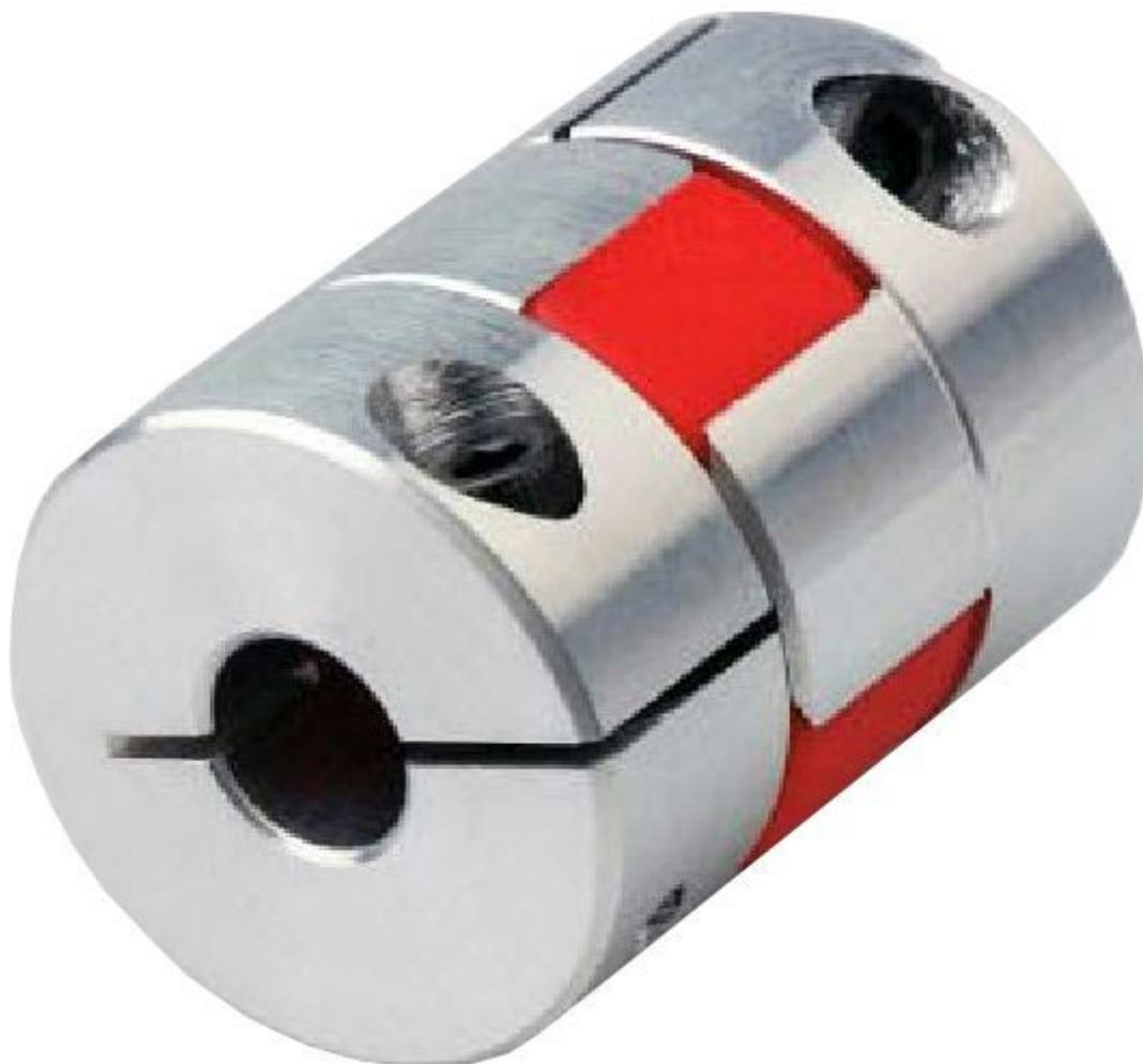
Realizzato in alluminio e dotato di foro da 10 mm da un lato e 12 mm dall'altro, questo giunto permette di accoppiare alberi motore, barra filettate, ecc. Dimensioni (mm): lunghezza 40x30 di diametro esterno. Particolarmente indicato per il motoriduttore da 12 V 9 rpm - 140 kg-cm utilizzato nel progetto della Fila extruder pubblicato sul numero 206 della rivista Elettronica In Giugno 2016.
