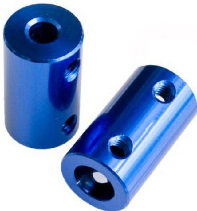
Giunto in alluminio che può essere impiegato in robotica, meccanica, ecc. Ad esempio può essere utilizzato per accoppiare una barra filettata M5 con l'albero (diametro 5 mm) di un motore passo-passo Nema 17. Diametro esterno 14 mm, altezza 25 mm. Completo di grani per serraggio.
