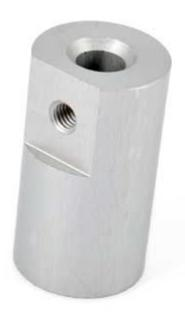
Realizzato in alluminio, questo giunto permette di accoppiare una barra filettata M8 con l'albero (diametro 5 mm) di un motore passo-passo. Particolarmente indicato per la stampante 3DRAG. Diametro esterno 14 mm, altezza 25 mm. Completo di grano per serraggio.
